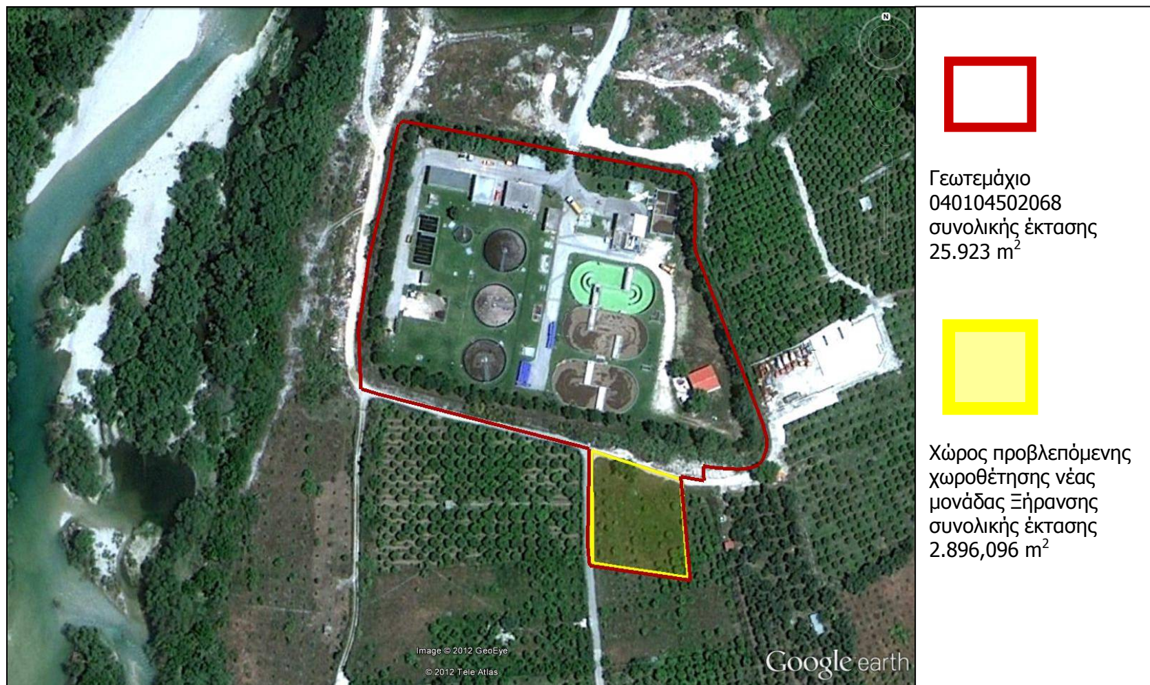
Δορυφορική Εικόνα 2.1: Χωροθέτηση Υφιστάμενης ΕΕΛ και νέας μονάδας ξήρανσης
